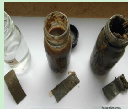
Testergebnis: Keine Korrosion durch Zuckerrübensilage.
